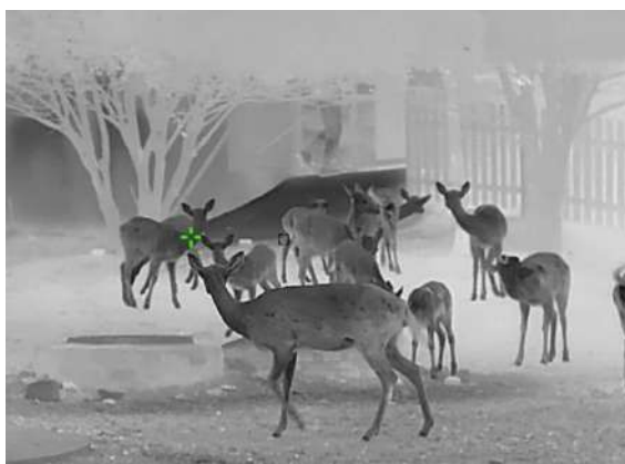
Figure 5-3 Suivi de point chaud
